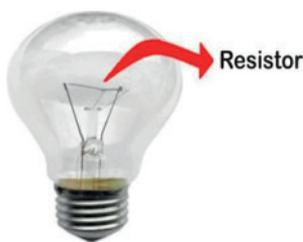
Independente da função do aparelho eletrônico a energia térmica sempre será gerada mesmo que em pequena quantidade devido a presença do resistor como parte dos seus componentes. Qualquer resistor sofre aquecimento quando é percorrido pela corrente elétrica. Esse aquecimento pode ser desejável, dependendo da função do aparelho, ou indesejável, caso dos circuitos de computadores, porque deixa seu processamento mais lento e pode danificar seus componentes.
