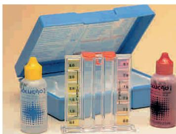
Figura 4 : Kit utilizado para medir o pH e a concentração de cloro em piscinas.
