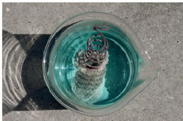
Figura 4 : Precipitação de prata em cobre a partir de uma solução de nitrato de prata
