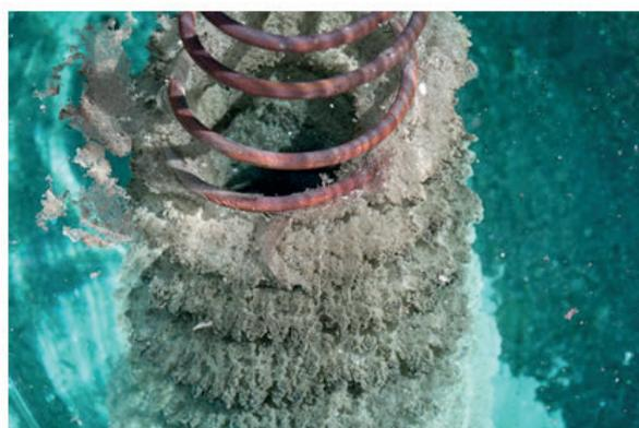
Figura 5 : Reação de oxirredução entre o cobre do espiral e a solução de nitrato de prata
