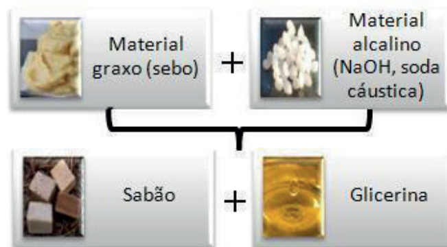
Figura 1: Reagentes e produtos da reação de saponificação.
